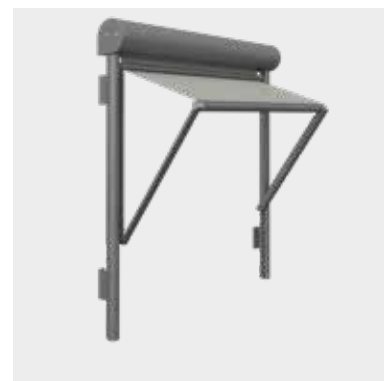
MARKISOLETTE R122 con cassonetto tondo Larghezza max. 3000 mm Sporgenza max. 3500 mm
